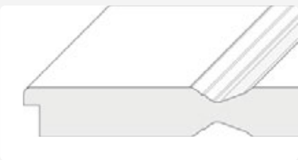
Türblatt mit innen liegenden Hohlprofilen, Einlage aus Röhrenspanplatten
