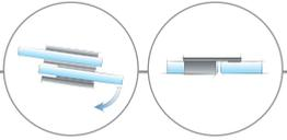
FLUTURE ist Kubismus pur: Durch die Anordnung der Beschläge im oberen und unteren Bereich des Glastürflügels entsteht ein Höchstmaß an Transparenz und Funktionalität. Das wichtigste FLUTURE-Merkmal ist die Klemmung am Türflügel. Sie ermöglicht die stufenlos regulierbare Überlappung und damit zugleich den einfachen Ausgleich bauseits vorhandener Toleranzen. Mit dieser Technik lassen sich Projekte optimal vorplanen und zügig umsetzen.
