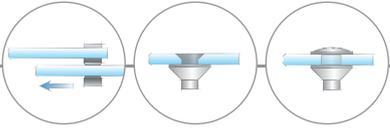
VIVERE ist der designorientierte Schiebetürbeschlag von Pauli + Sohn und für jeden Raumbedarf die richtige Wahl. Geeignet für Nischen-, Eck- und U-Duschen, bewährt aber auch für Großraumduschen. Technisch glänzt das VIVERE-System mit der exzentrisch höhenverstellbaren Glastür und den in drei Achsen verstellbaren Winkelhaltern für eine perfekte Anpassung.
