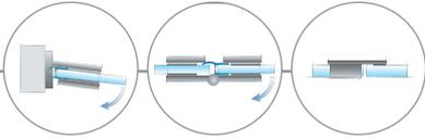
Ausdrucksstarke Eleganz und innovative Magnettechnologie: PAPILLON ist der State of the Art von Pauli + Sohn. Das einseitig nach außen öffnende Anschlagtürband überzeugt durch seine innovative Schließtechnik. Die wartungsfreie Magnettechnologie schließt das Band aus jeder Position.
