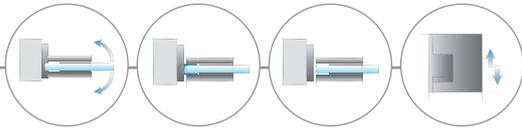
PAVONE wurde mit dem Ziel entwickelt, die positiven Eigenschaften verschiedener Duschtürbänder in einer Serie zu vereinen. Die Flächenbündigkeit für einen hohen Reinigungskomfort wird kombiniert mit den Vorzügen der Pendelfunktion. Außerdem hebt sich die Tür im Öffnungsvorgang an und senkt sich im Schließvorgang in eine stufenlos justierbare Nulllage. Diese Serie spielt Ihre Stärken bei einer barrierefreien Badplanung mit hohem Anspruch an die Ästhetik der Duschkabine aus.
