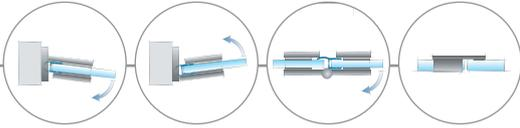
FLINTER entfaltet seine ganze Kraft vor allem in Badewannen- und Falttüranlagen. Die Federtechnik sorgt für eine feste Einrastfunktion des Türflügels. Je nach Größe und Gewicht des Türflügels und der Art des Türanschlags haben Sie die Wahl zwischen null und drei Federn. Für Falttüranlagen empfehlen die Experten von Pauli + Sohn die Kombination mit FLAMEA+ als Wandbeslag. Damit lässt sich der Türflügel zum Reinigen optimal nach außen öffnen. Fehlbedienung ausgeschlossen!
