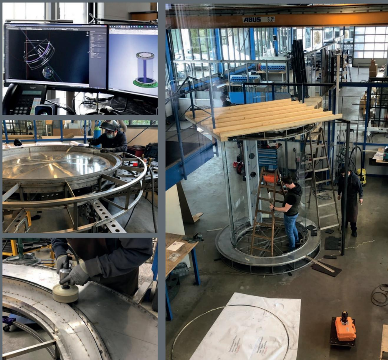
MWE Edelstahlmanufaktur in Kooperation mit dem Ahrensburger-Glasbau-Team entwickelten dieses Projekt als tadellose Ingenieursleistung und setzten es perfekt um. Die Duschtasse mit Unterkonstruktion, alle technischen Vorbereitungen und die gebogenen Spezialgläser wurden vorab gefertigt und in den Hallen von MWE wurde die gesamte Anlage einmal Vormontiert und die Funktion getestet.
